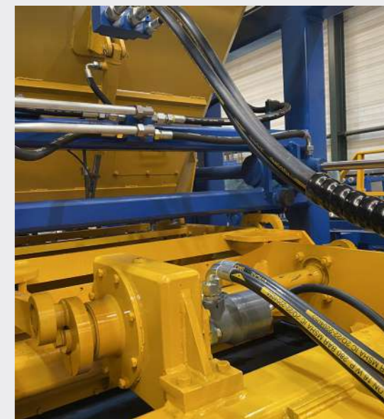
Alimentador de cajón con control láser
